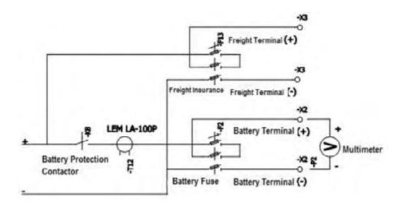
5. Если напряжение линейки АКБ имеет правильную полярность и находитсявдопустимомдиапазоне, включите батарейный выключатель выпрямителя (СВ2). Выпрямитель определит напряжение линейки батарей и включит контактор защиты от глубокого разряда АКБ. Начнется процесс заряда батарей. Проконтролируйте на дисплее устройства увеличение значения зарядного тока.
