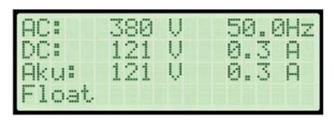
Проверьте показания напряжения АКБ и зарядного тока
